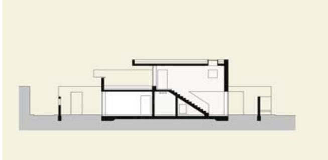
Raffiniert stützten die Architekten die Dachterrasse der Reihenhäuser über die Erdgeschosswohnungen und ermöglichen großzügiges „Durchwohnen“. Die zentrale Erschließungstreppe wird durch Oberlichter belichtet.
